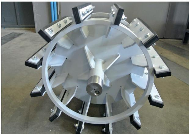
Stabtrommel mit Gummiteilen
